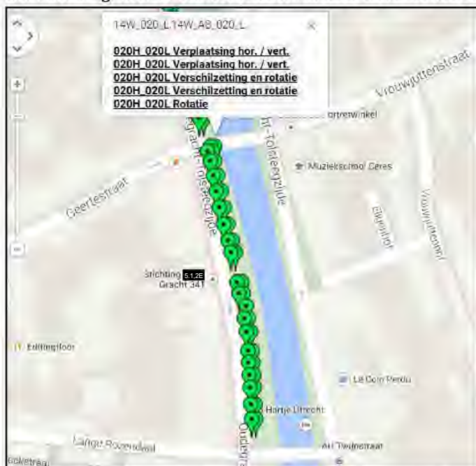
Figuur 2: locaties prisma's op de werfmuur [Bron: WePGIS]
